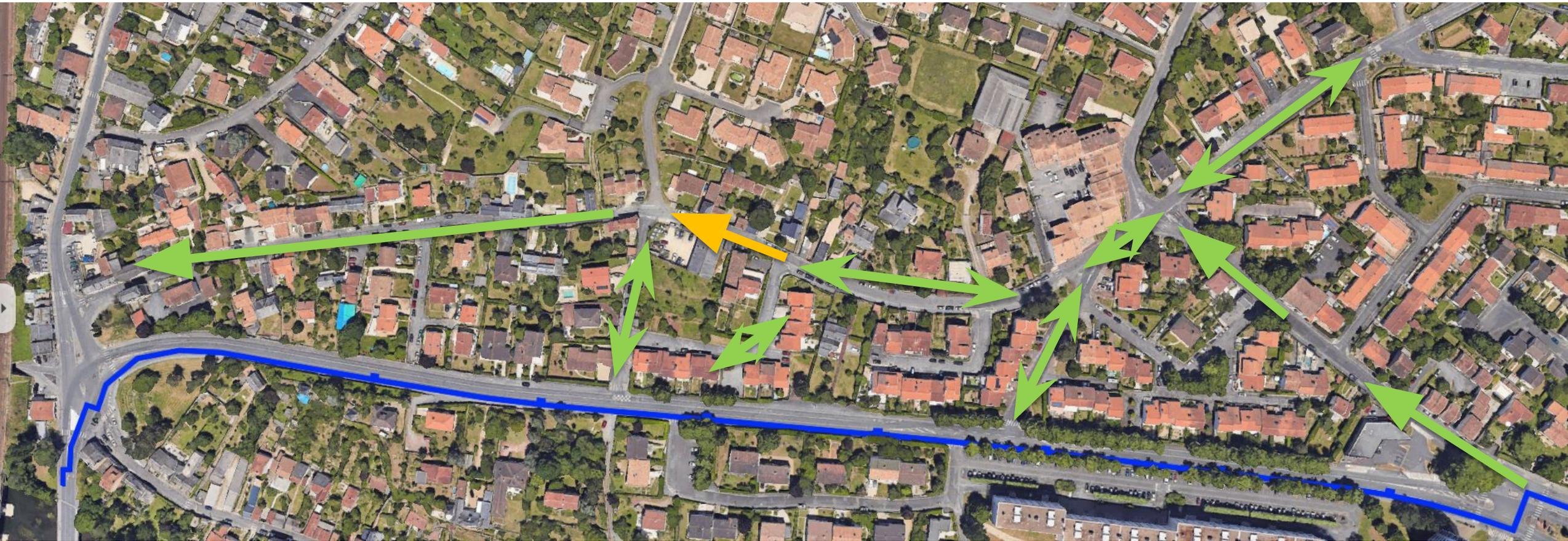
2 ème disposition: A partir de la rue des Mauges suppression du stationnement et mise en place de balisettes k16 pour permettre un cheminement piétons et un passage vélos
